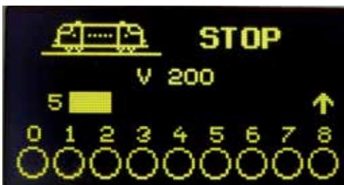
На дисплее отображается вся информация о локомотиве, скорости, направлении движения и состоянии специальных функций локомотива или о текущем выбранном режиме работы (например, положение переключателей в стрелочном режиме).
